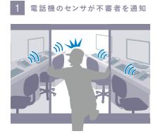
セーフティモードでは、電話機のセンサ が自動で作動します。異常を検知した際 は、電話機の大音量とLEDで不審者を 威嚇します。
